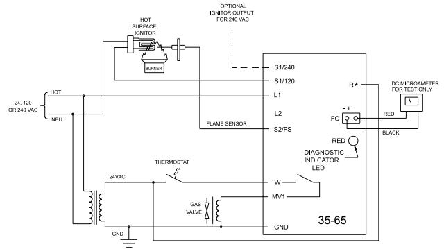
\* R TERMINAL IS ONLY USED ON CONTROLS WITH FULL TIME POWER
